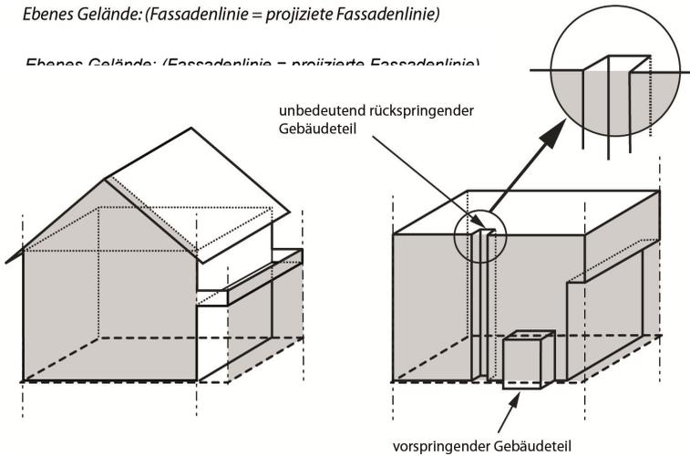
Figur 2.2.a Fassadenflucht und Fassadenlinie (in ebenem Gelände)
