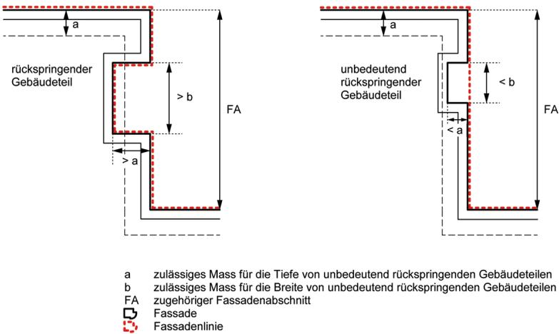
Figur 2.4 Rückspringende und unbedeutende rückspringende Gebäudeteile
