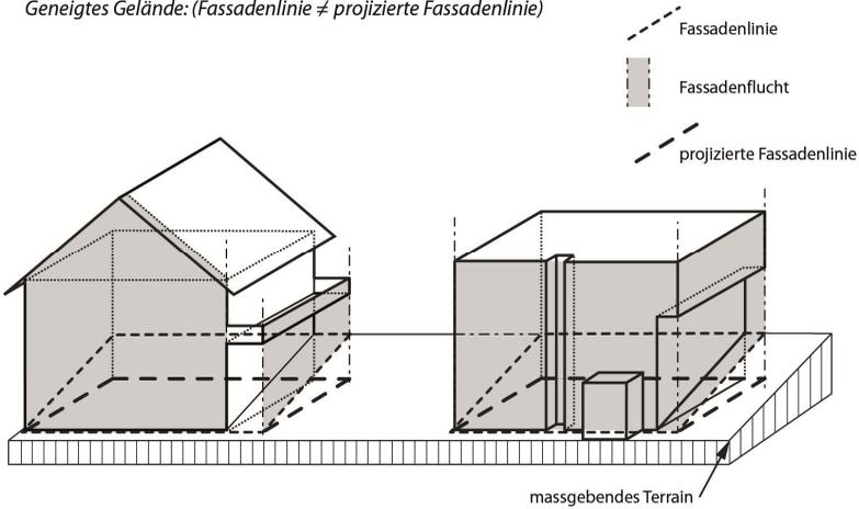
*Figur 2.2.b Fassadenflucht und Fassadenlinie (in geneigtem Gelände)*
